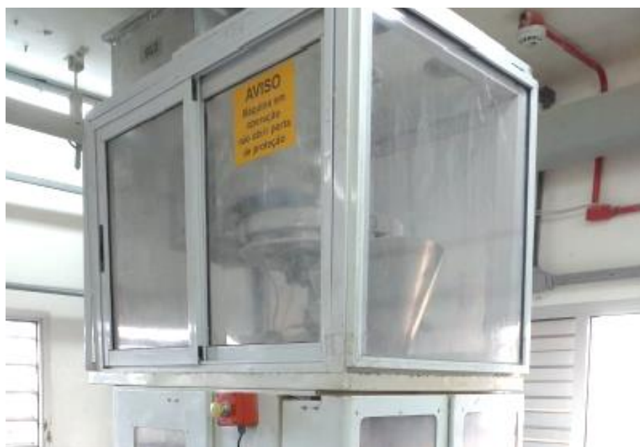
Figura 19 - Proteção móvel da máquina de envase
