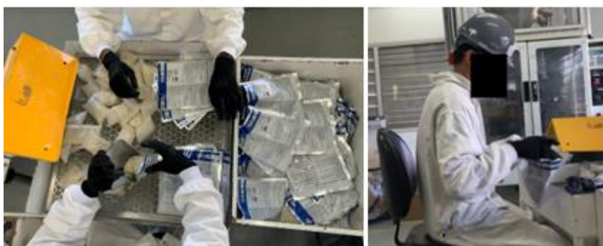
Figura 9 - Inserção dos sachês hidrossolúveis em embalagens metalizadas
